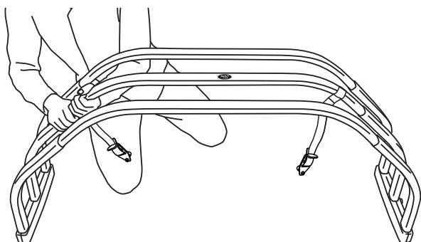
Nota: Asegúrese de que las correas ya estén instaladas en el tubo central antes de completar el ensamblaje.
