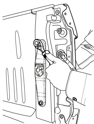
Con una llave de tubo de 13 mm, apriete el sujetador inferior, sosteniendo la tuerca en la cavidad de la lámpara en su lugar con una llave de caja de 13 mm.
