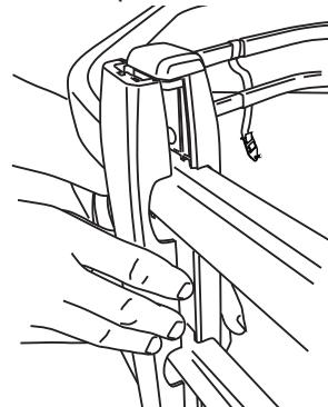
El montante vertical no está colocado en el centro de la unión del tubo.
