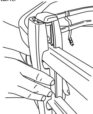
Le montant n'est pas placé au centre du joint du tube.
