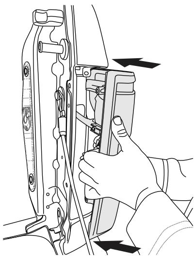
Serrer la fixation de la lampe supérieure à 0,9 Nm / 5.4Ft-lb.
