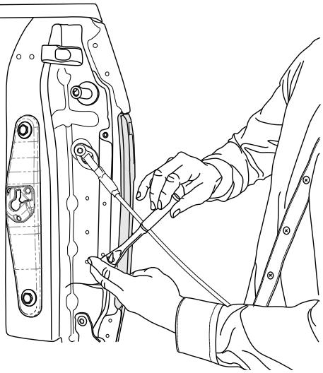
Soporte del lado del conductor instalado.
