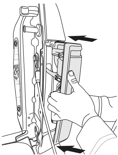
Apriete el sujetador de la lámpara inferior a 5.4 ft-lb/ 0.9 Nm.
