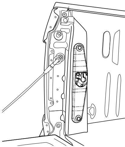
Apriete el sujetador de la lámpara superior a 5.4 Ft-lbs / 0.9 Nm.
