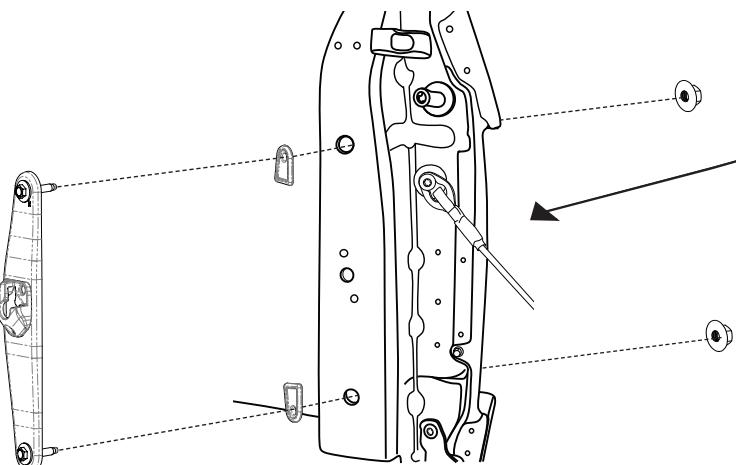
En tenant les boulons et le support en place, serrez à la main les écrous (F) pour visser les extrémités dans la cavité de la lampe.
