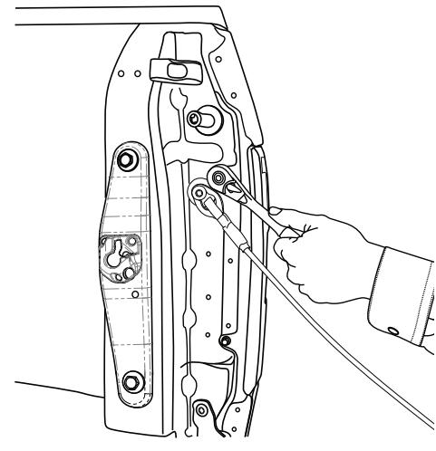
Serrer la fixation de la lampe inférieure à 0,9 Nm / 5.4Ft-lb.
