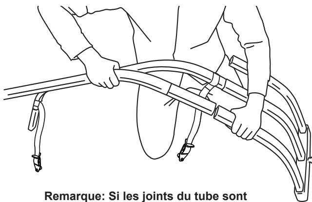
Remarque: Si les joints du tube sont serrés, vous pouvez utiliser de l'eau savonneuse.
