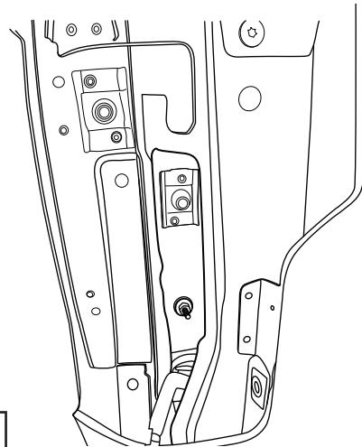
**NOTA:** Asegúrese de que las tuercas estén centradas correctamente sobre el orificio del pilar D dentro de la cavidad de la lámpara.
