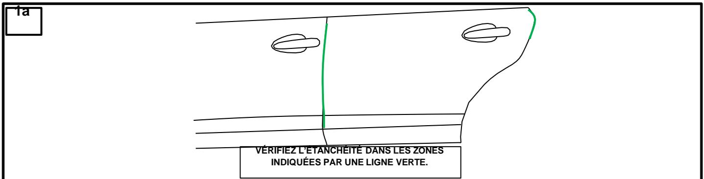
Avant l'installation, confirmez qu'il y a un dégagement suffisant entre le bord de la porte et le bourrelet d'étanchéité pour veiller au bon positionnement de la protection de bord de porte.
