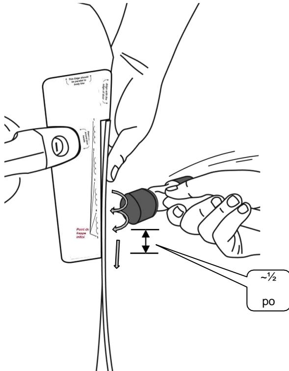
CONTINUER EN FRAPPANT FERMEMENT VERS LE HAUT ENTRE LE POINT DE FRAPPE N°1 ET 4 À 1/2 PO D'INTERVALLE.
