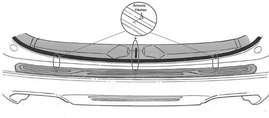
**ÉTAPE 4 :** Pendant que la pièce est en position d'origine, repérez les gabarits d'alignement des coins gauche et droit fournis. En utilisant la pièce comme guide, positionnez le gabarit de droite, puis celui de gauche. Assurez-vous que les gabarits sont placés contre le mur vertical arrière et alignés avec le profil de la pièce, puis appliquez du ruban adhésif pour coller les bords extérieurs des gabarits.
