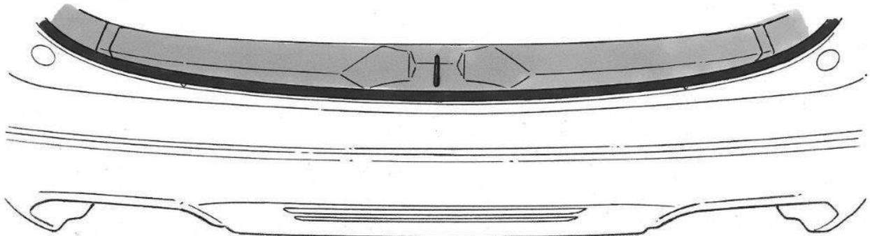
**ÉTAPE 1 :** Nettoyez les dépôts de poussière, d'huile ou de cire sur la zone de fixation du pare-chocs avec un chiffon propre et de l'alcool dénaturé. Préparez ensuite la surface avec les tampons d'alcool fournis.
