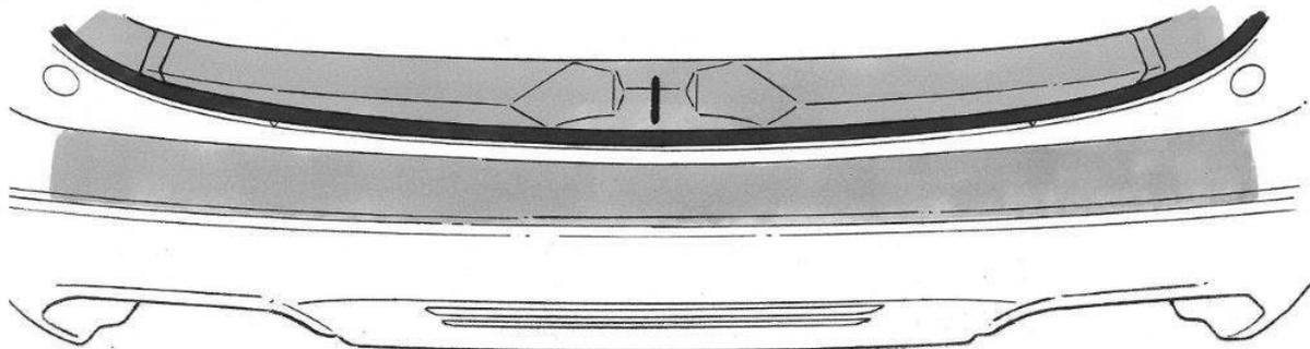
**ÉTAPE 2 :** Remarque : Si la température est inférieure à 15 °C (60 °F), chauffez la bande adhésive double-face et la surface du pare-chocs pour atteindre une température de 27 °C (80 °F).
