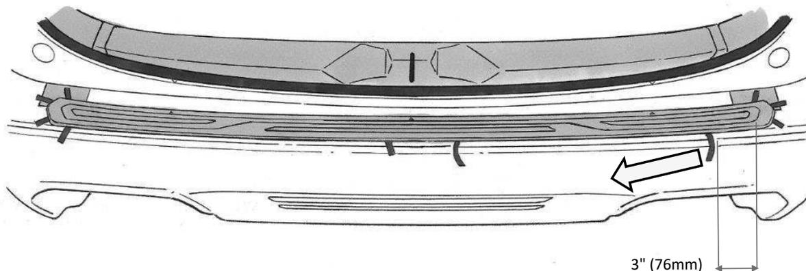
**ÉTAPE 10 :** Inspectez soigneusement et alignez (si nécessaire) le côté de la pièce avec le pare-chocs, puis appuyez sur la pièce avec un doigt, exclusivement à l'emplacement indiqué ci-dessous. N'appuyez nulle part ailleurs.
