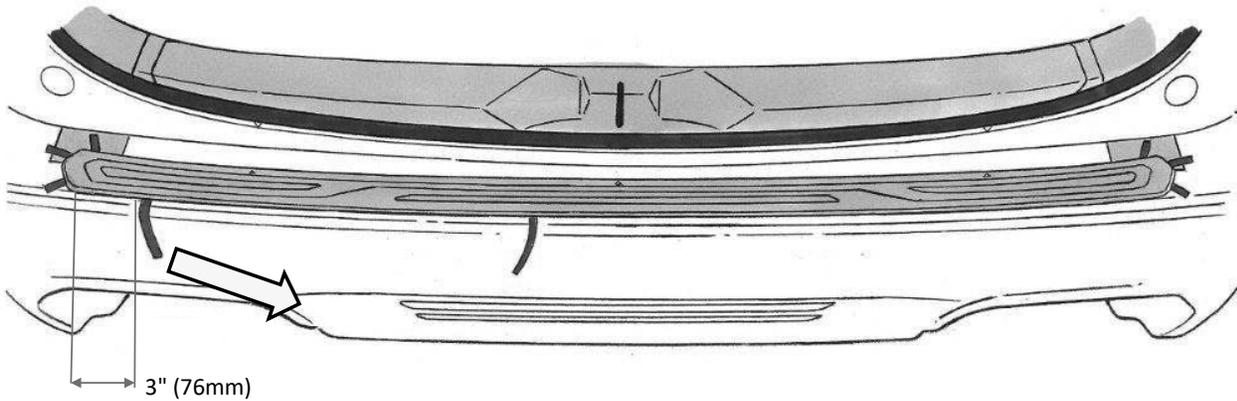
**ÉTAPE 16 :** Inspectez soigneusement et alignez (si nécessaire) le côté de la pièce avec le pare-chocs, puis appuyez sur la pièce avec un doigt, exclusivement à l'emplacement indiqué ci-dessous. N'appuyez nulle part ailleurs.
