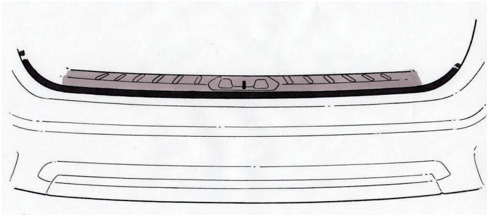
**ÉTAPE 1 :** Nettoyez les dépôts de poussière, d'huile ou de cire sur la zone de fixation du pare-chocs avec un chiffon propre et de l'alcool dénaturé. Préparez ensuite la surface avec les tampons d'alcool fournis.
