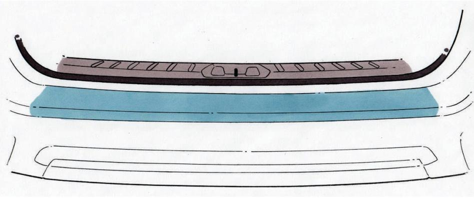
**ÉTAPE 2 :** Remarque : Si la température est inférieure à 15 °C (60 °F), chauffez la bande adhésive double-face et la surface du pare-chocs pour atteindre une température de 27 °C (80 °F).
