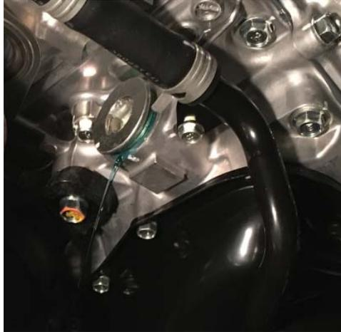
7. Appliquez le composé haute température de joint d'étanchéité sur les filets de l'élément chauffe-moteur et installez le chauffe-moteur dans l'ouverture du bouchon expansible, serrez avec des pinces ajustables jusqu'à ce que le joint soit bien assis sur le bloc moteur. Informations de référence: La valeur de couple du bouchon du chauffe-moteur: 90 [N-m] / 66,4 [pi-lb].
