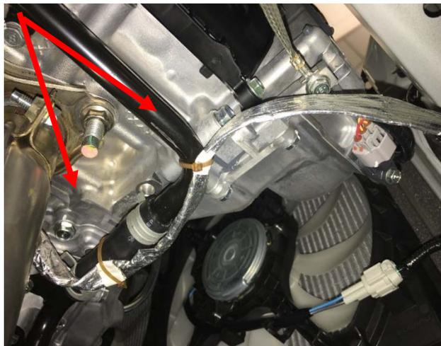
15. Branchez le harnais de câbles dans l'élément du chauffe-moteur. Orientez le connecteur orange vers le devant en tournant le connecteur orange à l'intérieur du chauffe-moteur. L'intérieur du chauffe-moteur peut être orienté selon le boîtier extérieur.
