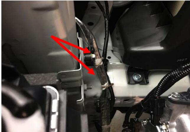
13. Fixez le harnais de câbles du chauffe-moteur au harnais de câbles du véhicule juste sous le longeron du cadre de châssis à l'aide d'une attache haute température.
