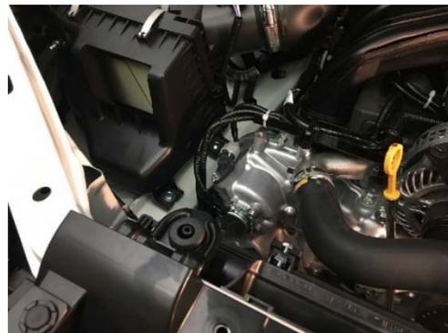
10. Introduisez le connecteur orange de l'élément chauffe-moteur par l'ouverture d'admission d'air située dans la partie supérieure de la calandre avant vers le radiateur. À l'aide d'un protecteur de fiche mâle, fixez le connecteur mâle sur la calandre tel qu'indiqué.
