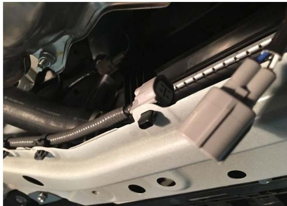
4. Abaissez lentement le tuyau d'échappement avant en retirant les 6 écrous de fixation pour accéder au bouchon expansible fileté.
