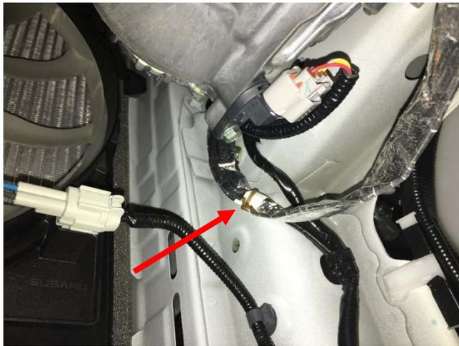
14. Fixez le harnais de câbles à la conduite du liquide de refroidissement aux deux emplacements indiqués en utilisant 2 attaches haute température.
