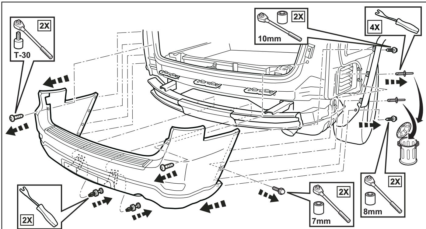
2. Destornille y desmonte el travesaño existente. Deseche el travesaño y todos los sujetadores.
