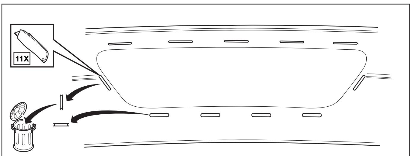
9. Corte la abertura central del bisel conforme al trazo de las aberturas que se ilustra. Deseche la sección que cortó.
