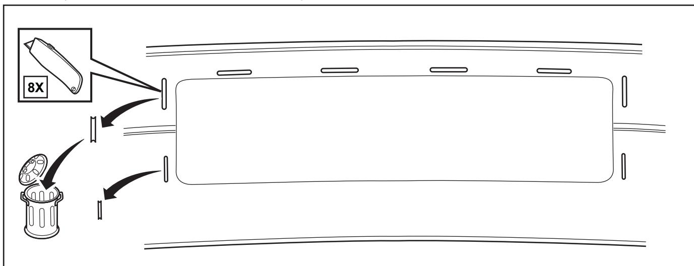
6. Corte la abertura central del bisel conforme al trazo de las aberturas que se ilustra. Deseche la sección que cortó.
