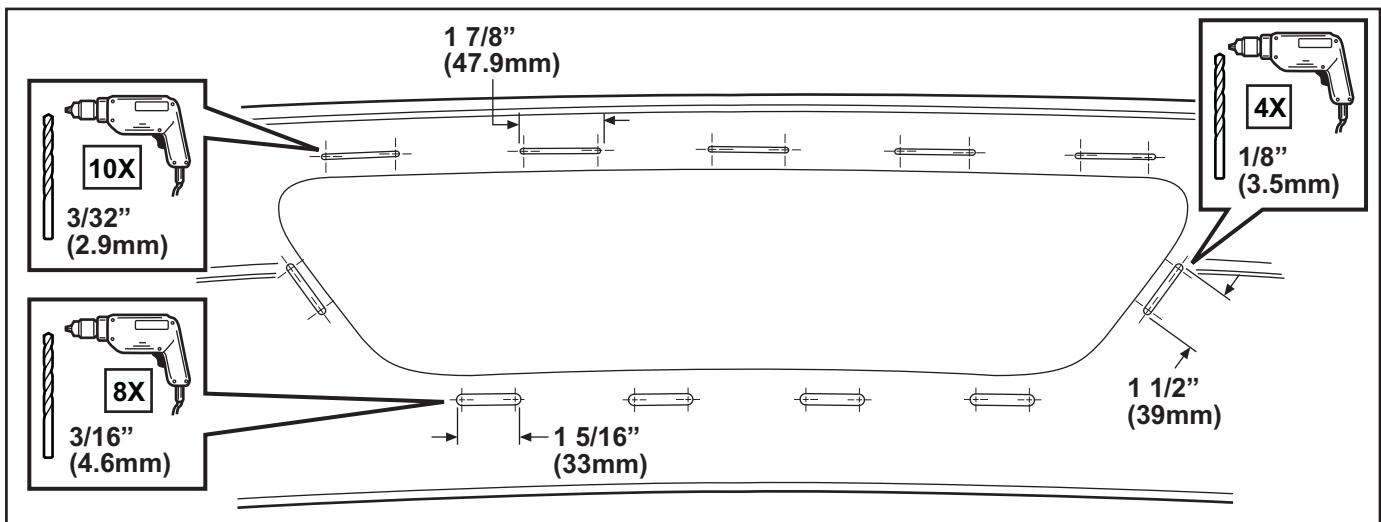
8. Corte las áreas sobrantes de las aberturas de lengüeta con una cuchilla de usos generales conforme al trazo de las áreas que se ilustran. Deseche las secciones que cortó.
