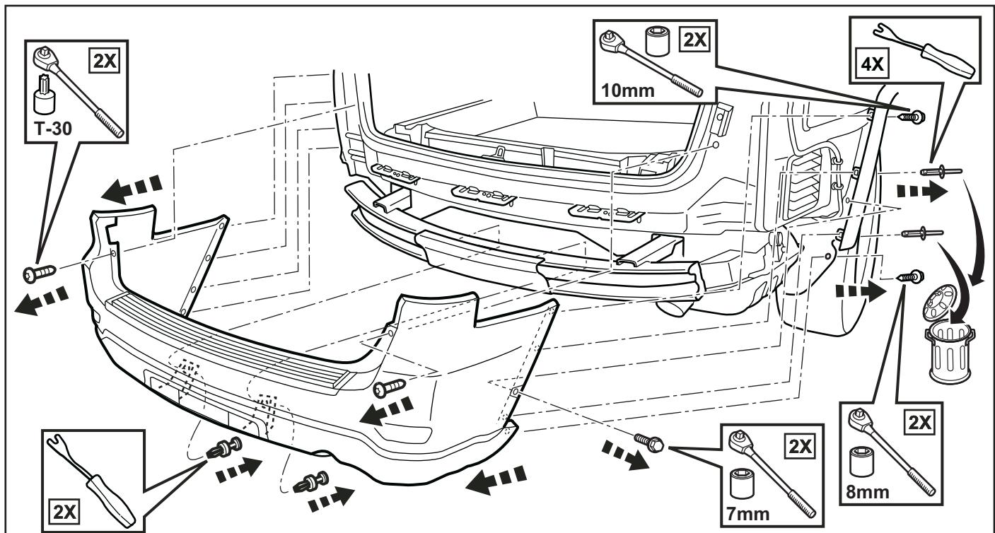
2. Déboulonner et déposer le support transversal et mettez-le au rebut ainsi que toute la quincaillerie de fixation.
