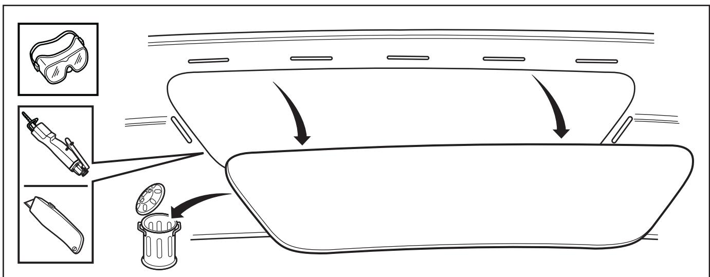
10. Presione el bisel en la abertura del guardabarros. Compruebe que todas las lengüetas están firmemente ajustadas a presión y fije con los dos (2) broches de resorte según se ilustra.
