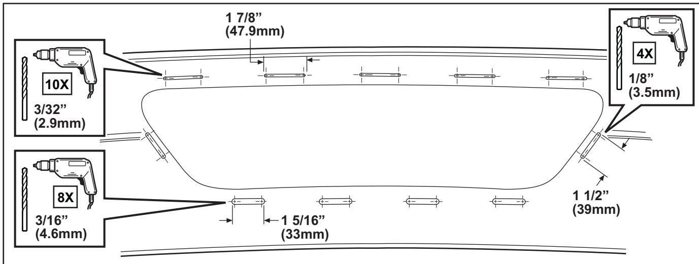
8. À l'aide d'une lame ou couteau tout usage, découper le reste des fentes comme montré au dessin et mettez au rebut les sections retirées.
