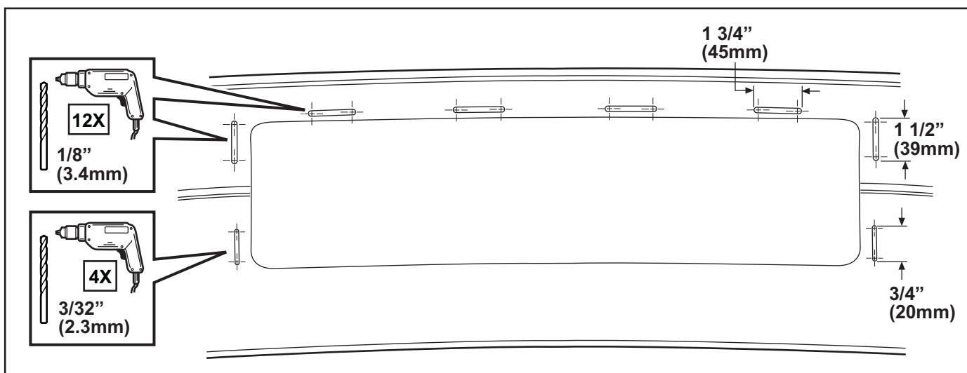
5. Corte las áreas sobrantes de las aberturas de lengüeta con una cuchilla de usos generales conforme al trazo de las áreas que se ilustran. Deseche las secciones que cortó.
